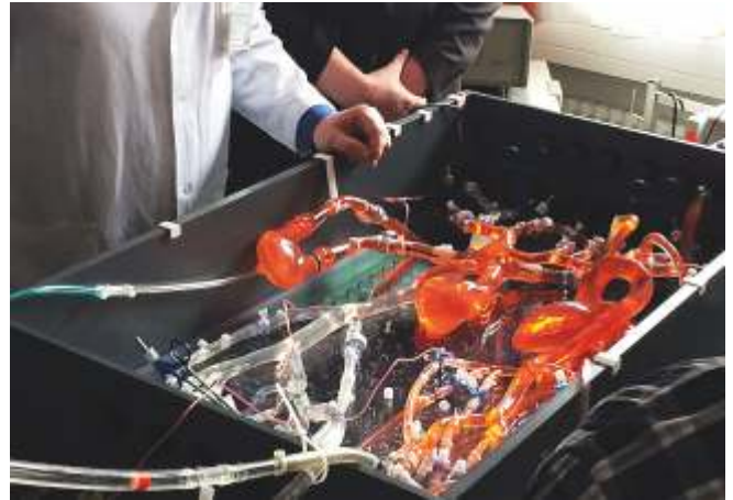
Die metallfreie Konstruktion des Kreislaufsimulators ermöglicht auch MRT-Untersuchungen
