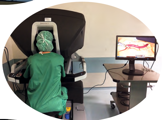
Die Steuerkonsole: Meter entfernt vom Patienten operiert der Chirurg von hier aus mit bester Sicht, die von einer hochauflösenden Minikamera aus dem Operationsfeld übertragen wird
